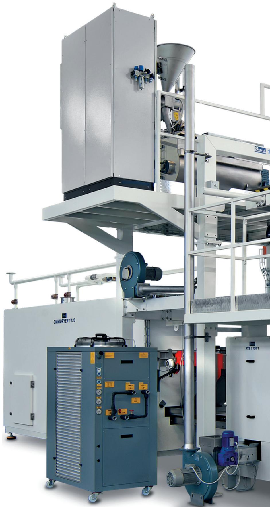
Il **pre-essiccatore Omnidryer**, grazie alla sua particolare conformazione interna, permette di deviare i flussi d'aria e adeguarli al formato di pasta che in quel momento si desidera produrre. Tale conformazione interna variabile, brevetto esclusivo Storci è l'unica al mondo che permette di pre-essicare sia le paste lunghe che quelle corte ed i formati speciali senza modificare la linea.
