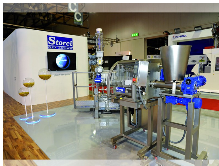
Автоматическое формовочное устройство для производства тортеллини на выставке Ipack Ima 2015
